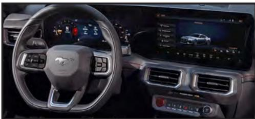
L'intérieur dispose désormais d'un affichage numérique incurvé composé d'un écran central de 13,2 pouces et d'un combiné d'instruments de 12,4 pouces ; boutons
